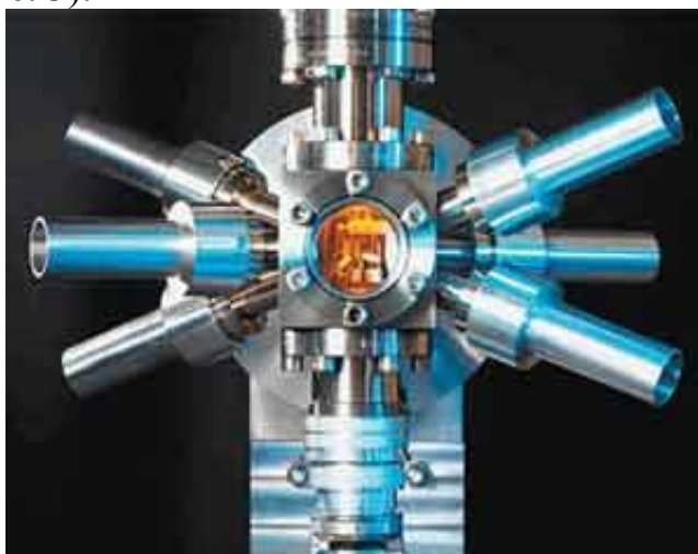
Рис. 3. Фото радио оптического частотного моста - эталона времени
