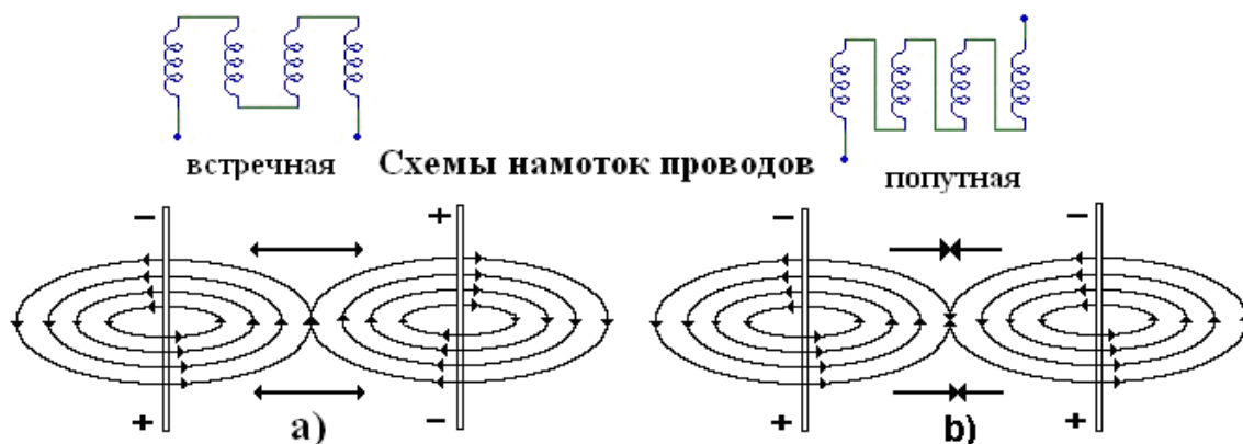
Рис. 15. Схемы намоток проводов и взаимодействия их магнитных полей
