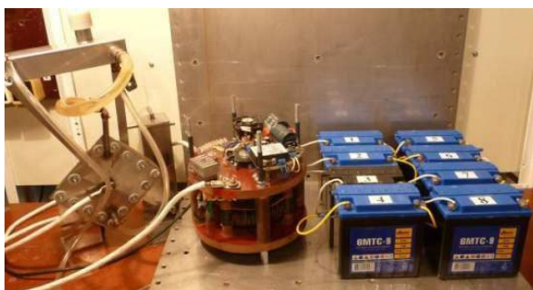
Рис. 18. Импульсный электродвигатель-генератор МГ-1 в работе
